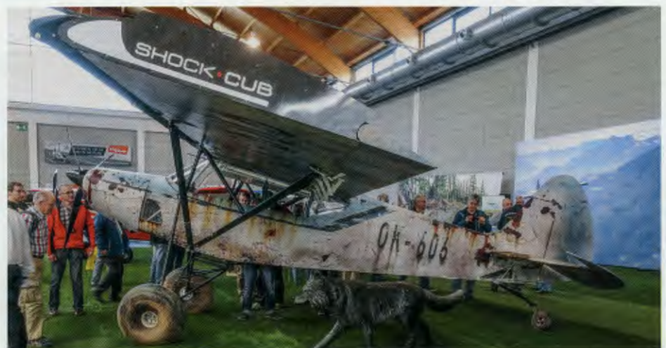
Sie ist nur 600 Kilo leicht und erregte an der AERO sehr viel Aufsehen wegen ihres Aussehens: die als «fliegender Schrotthaufen» getarnte Shock-Cub, eine tschechisch-italienische Leichtkopie der Piper Cub, die sich für extreme Buscheinsätze eignet. Schweizer Vertreter ist Philipp Sturm, der sie auch in Alaska vertreibt.
